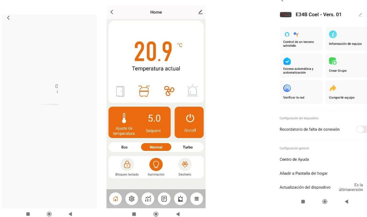
La pantalla de Inicio le permite activar algunos comandos en el controlador, como activar el deshielo, bloquear el teclado, encender/apagar la luz, encender/apagar el controlador, cambiar el Set-Point y cambiar el modo de funcionamiento (Eco, Normal, Turbo). Esta pantalla también muestra el valor de temperatura leído por la sonda 1 (Pr1 – Ambiente) e indica el estado del compresor, ventilador, puerta, alarma.
